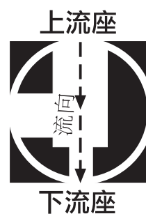
圖 B 閥門處於“試驗”位置。流體由閥門入口經過球體孔流向直行出口，然後流入減壓閥。
