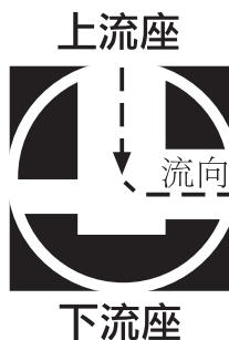
圖 A 閥門處於“關閉”位置。流體由閥門入口流向側面減壓閥。
